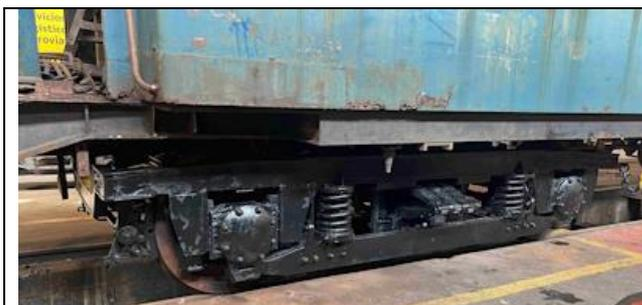
Das sanierte Drehgestell ist unter dem Wagenkasten montiert. Man sieht auch die rostigen Stellen am Wagen..Foto CEFU
